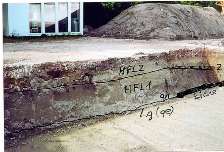
Abb. 3: Blick in die Baugrube Jahnstraße 7, Achern, mit der holozänen Auenlehmdecken (HFL 2 und HFL 1), der Lage der Holzkohleschicht mit Zwetschgen-Kernen (= Z, Profil-mittig rechts) und der Eichenstämmen (Holozän-Basis, qh), erosionsdiskordant lagernd auf elsterzeitlicher Grundmoräne, Lg/qe (Foto: Prof. Dr. D. ORTLAM, Bremen).
