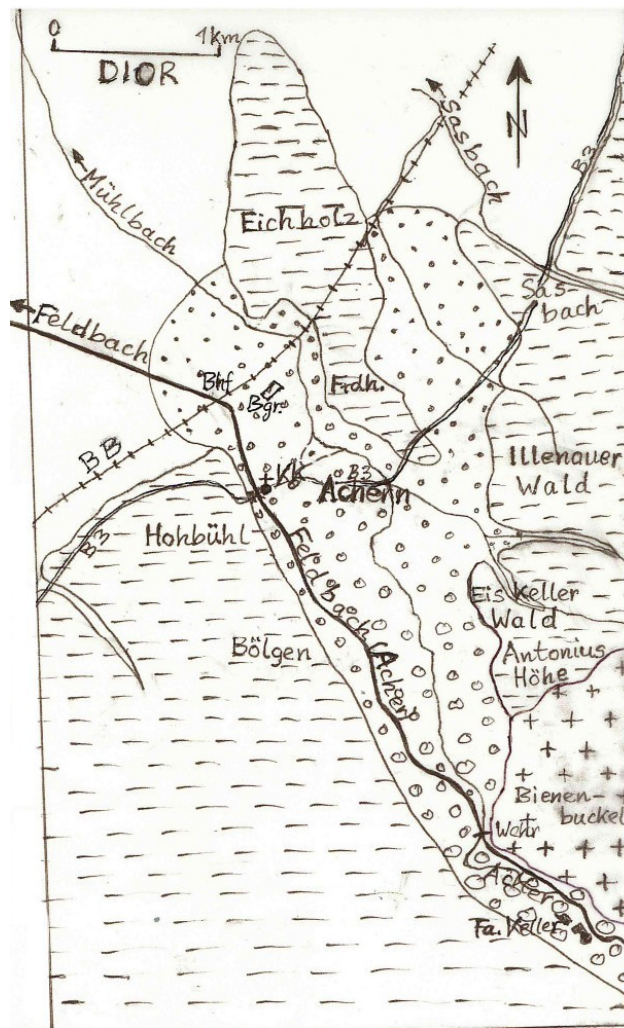
Abb. 1: Geologische Verhältnisse im Bereich des Acher-Deltas in der Vorbergzone bei Achern (Mittelbaden) mit der Lage der Baugrube (Bgr.) zwischen dem Friedhof und dem Bahnhof (ergänzt nach ORTLAM 2008).
