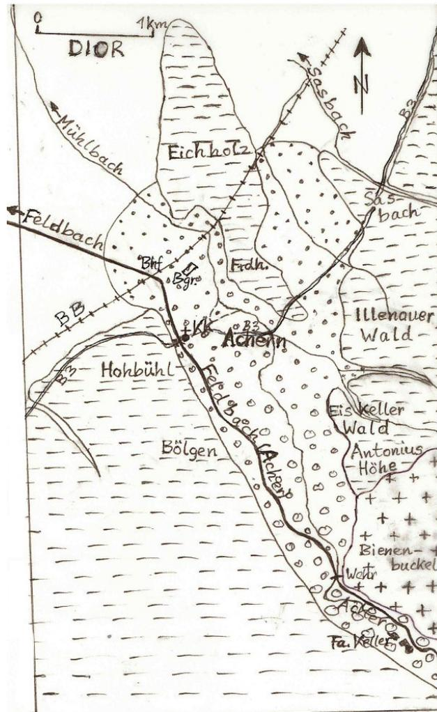
Abb. 1: Geologische Verhältnisse im Bereich des Acher-Deltas in der Vorbergzone bei Achern (Mittelbaden) mit der Lage der Baugrube (Bgr.) zwischen dem Friedhof (Frhd.) und dem Bahnhof (Bhf., ergänzt nach ORTLAM 2008).
