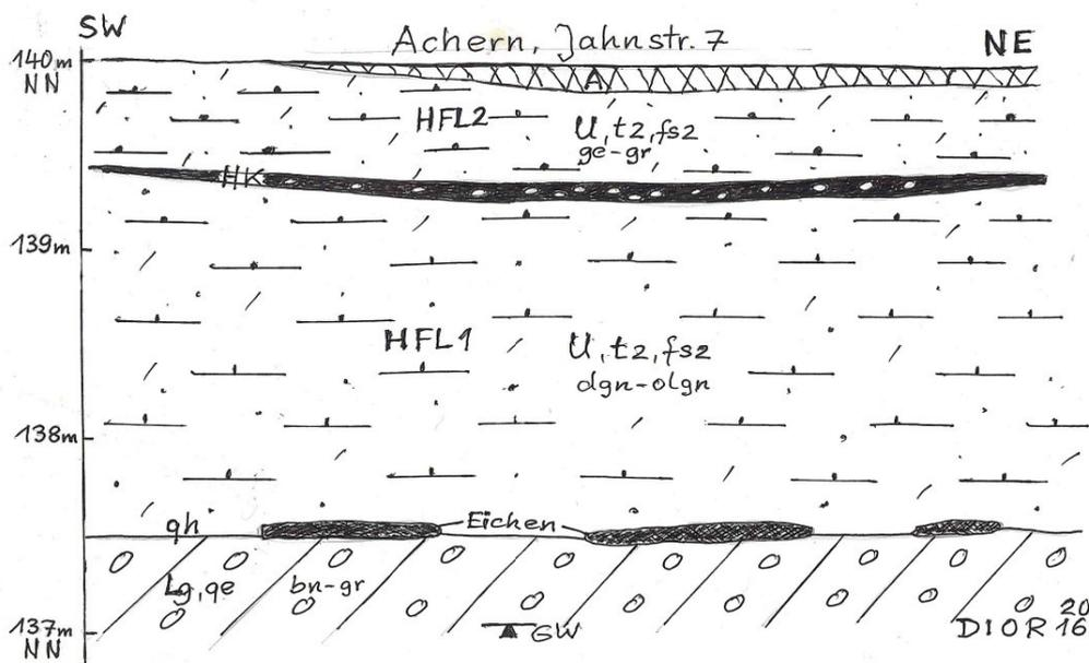
Abb. 5: Geologischer Schnitt durch die Baugruben Jahnstraße 7 (Achern) mit den mächtigen Hochflutlehm (HFL 1 und 2), der Holzkohleschicht (HK) und den Eichenstämmen auf dem Acher-Delta mit elsterzeitlicher Grundmoräne als Sockel; GW = gespannter Grundwasserspiegel.
