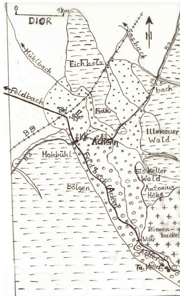
Abb. 1: Geologische Verhältnisse im Bereich des Acher-Deltas in der Vorbergzone bei Achern (Mittelbaden) mit der Lage der Baugrube (= Bgr.) zwischen dem Friedhof (= Frdh.) und dem Bahnhof (= Bhf. von Achern (ergänzt nach ORTLAM 2008)).
