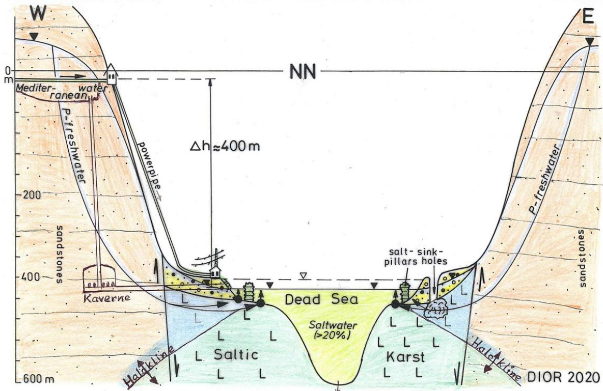
Abb. 3: Schematischer hydrogeologischer Schnitt durch das nördliche Tote Meer und den Auswirkungen der drastischen Meeresspiegelabsenkung seit 1950 mit verstärkten Erdfällen (onshore) und den Salzsäulen (offshore) – bedingt durch den DGH-Effekt. Modell für die ökologische Regeneration des Toten Meeres mithilfe einer Zuleitung von Mittelmeerwasser (Trasse: Ashdod-Süd-Jerusalem-Speicherbecken-Totes Meer) auch zur Energie- und Süßwasser-Gewinnung.
